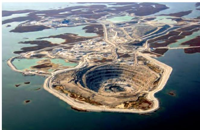
Unter dem Titel „Diavik“ führten die Bauer-Firmen mehrere Großaufträge in Kanada aus. Nahe dem Polarkreis werden in der See Vulkanschlote abgedichtet. Wenn das Wasser abgepumpt ist, können im Tagebau Diamanten geborgen werden
