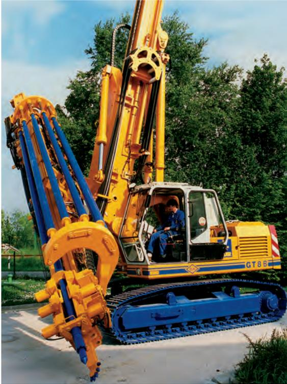
Erste vollautomatische Ankerbohrmaschine AB 2 mit Gestängemagazin 1989. Schlitzwandfräse zum Bau der 45 Meter tiefen Schlitzwand am Brombachspeicher 1984
