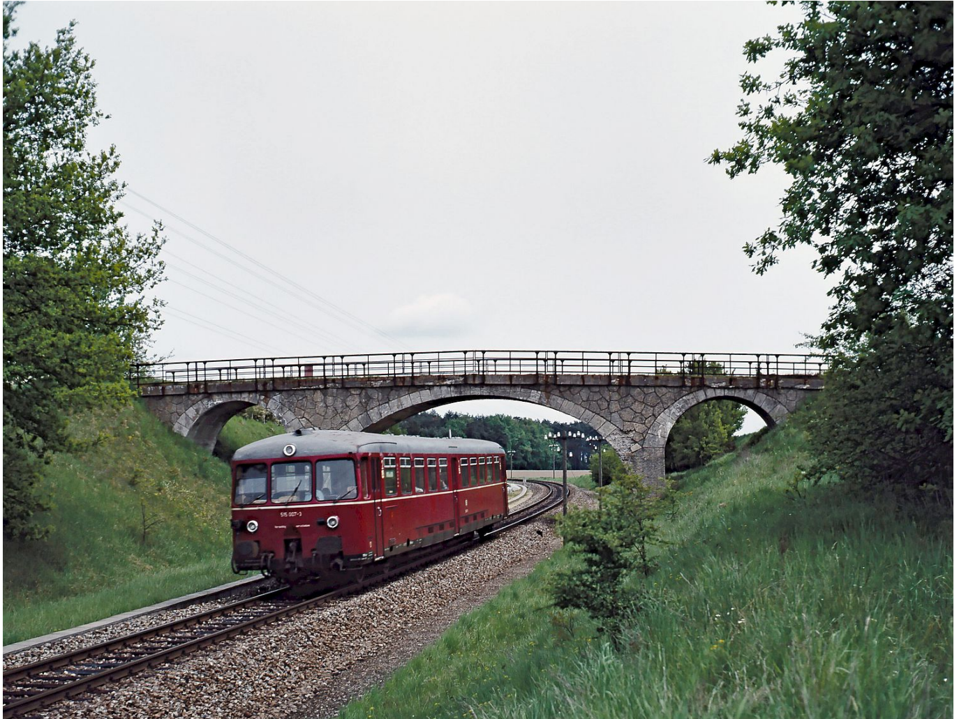
Leise surrend und emissionslos hat der Akku-Triebwagen 515 007 auf seinem Weg nach Schrobhausen gerade die Feldwegbrücke unweit der Königslachener Weg passiert. Das Bild dieser „vergessenen Innovation“ entstand um 1980. (Foto: Benno Bickel)
